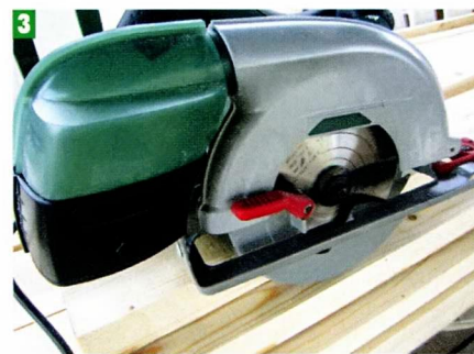
3 Раскраивать доски на заготовки удобнее всего ручной дисковой пилой. Рез получается довольно чистым и почти не требует дополнительной обработки.
