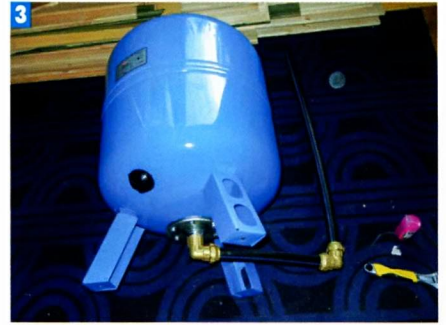
3 Расширительный мембранный бак ёмкостью 100 л нужен для компенсации скачков давления в водопроводе.
