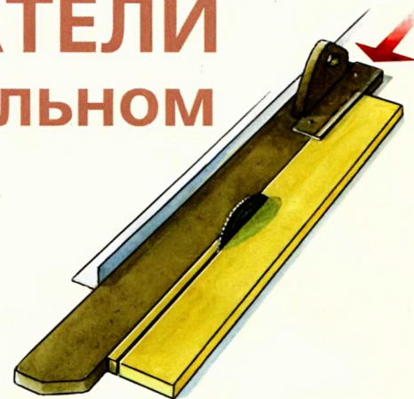
Рис. 1. Для отпиливания от заготовки длинных тонких планок и досылатель нужен длинный.
