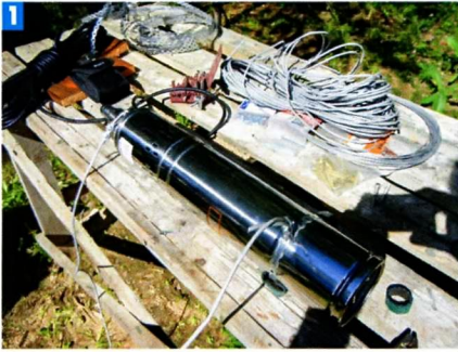
1 Воду из колодца в дом подаёт погружной винтовой насос. Ввод водопровода из ПНД-труб в дом выполнили в укромном углу.
